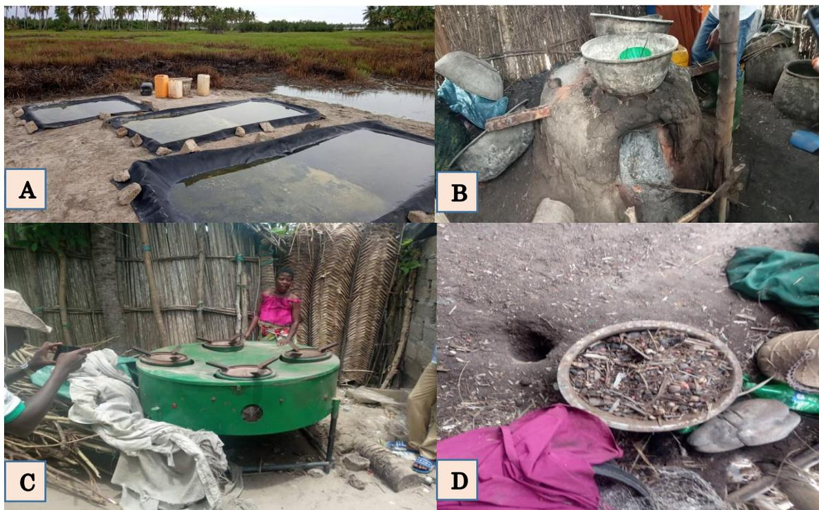
*Planche n°2 : A : Technique de production de sel utilisant les bâches ; B : Technique utilisant le bois de chauffe ; C : Foyer amélioré doté de plaque solaire ; D : Débris de coques grillées servant de combustibles pour le foyer amélioré*
